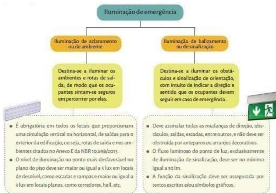
Figura 16 – Tipos de iluminação de emergência.
